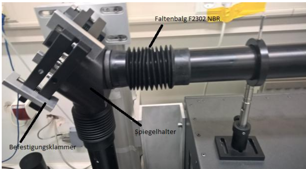
Abbildung 14. Befestigungsklammer und Faltenbälge zur Verbesserung der mechanischen Stabilität der Spiegelhalter
