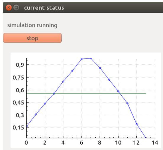
Abbildung 27: Fenster “current status” mit dem aktuellen Status des automatischen Suchlaufs in PulSi (Testpunkte: blaue Punkte; durchschnittliche Höhe der Testpunkte: grüne Linie)
