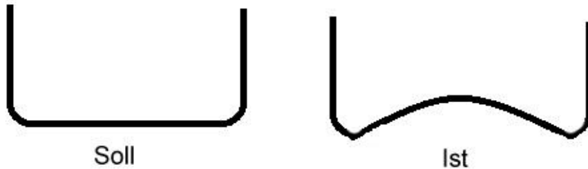
Abbildung 12 – Aufwölbung der Trichterauskleidung (Skizze)
