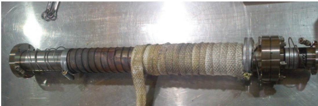
Abb. 5 neues Testmodell mit Heizung und Isolation aus Glasfaserband
