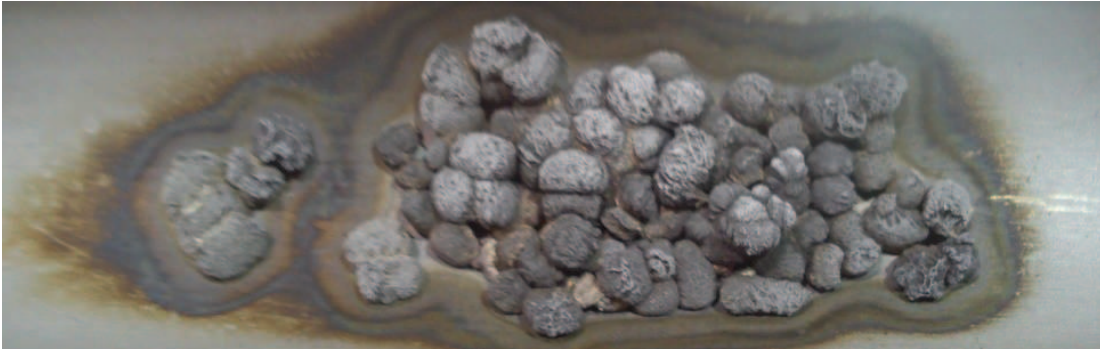
Abb. 16 Lithium in der Halbschale nach dem Aufheizen
