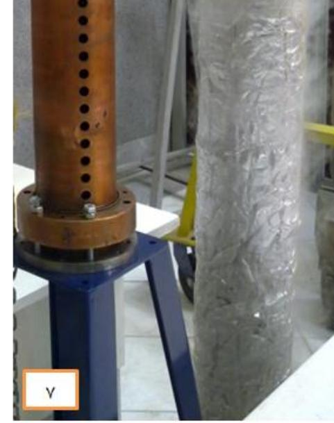
مراحل مونتاژ قسمت‌های تیوب شتابدهی به روش انقباضی؛ ۱- شمایی از نحوه جازدن صفحه‌ها، ۲- تهیه ازت مایع به میزان کافی، ۳- تست و بستن فیکسچر نگه‌دارنده صفحه‌ها، ۴- سوار کردن صفحه‌ها بر روی پایه تثبیت فاصله و بستن فیکسچر، ۵- مونتاژ تیوب پلی‌اتیلنی، ۶- تست اولیه هم‌ترازی و ۶- مونتاژ نهایی تیوب
