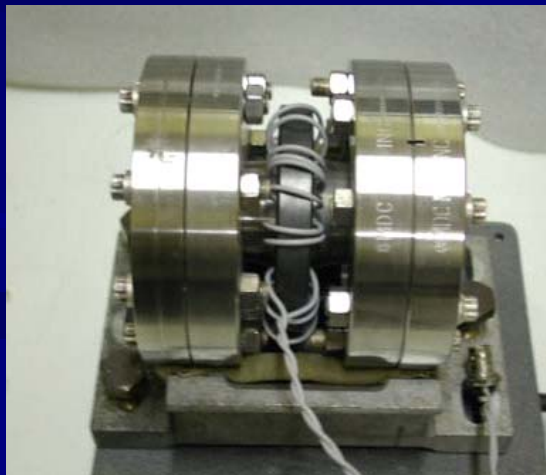
Actual current transformer
